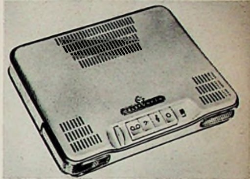
Bild 2. Telefunken-Zweikanalverstärker S 80, mit dem man auch einkanalige Rundfunkempfänger zu Stereo-Wiedergabeanlagen umgestalten kann, sowie ein Stereo-Plattenspieler und Außenlautsprecher vorhanden sind. Der Verstärker läßt sich auch einkanalig verwenden. Abmessungen: 310 × 230 × 60 mm
