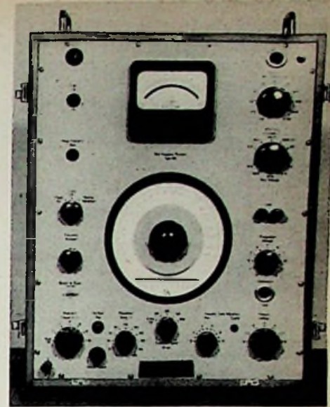
Bild 3. Schwebungssummer mit einer elektronischen Einrichtung zur Erzeugung von Heultönen (Brüel & Kjaer)
