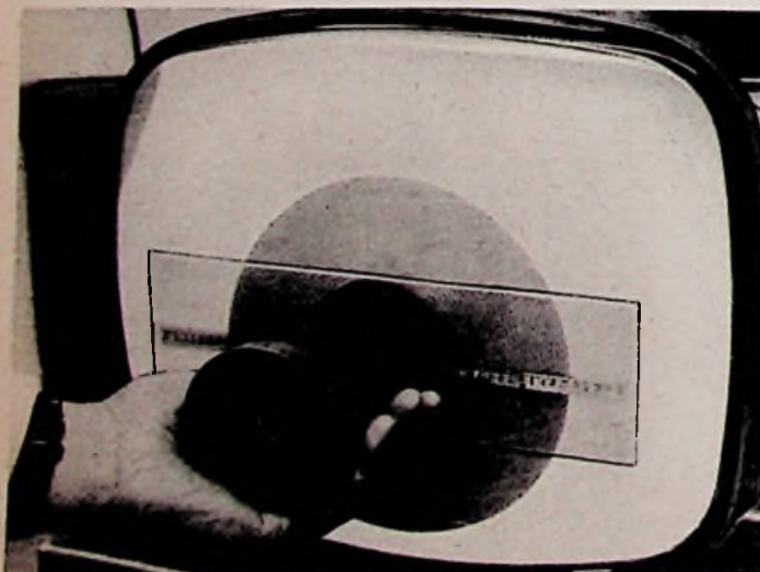
Bild 2. Beim Aufsetzen der Meßanordnung erscheint je nach Höhe der Hochspannung ein mehr oder weniger großer dunkler Kreis im Raster
